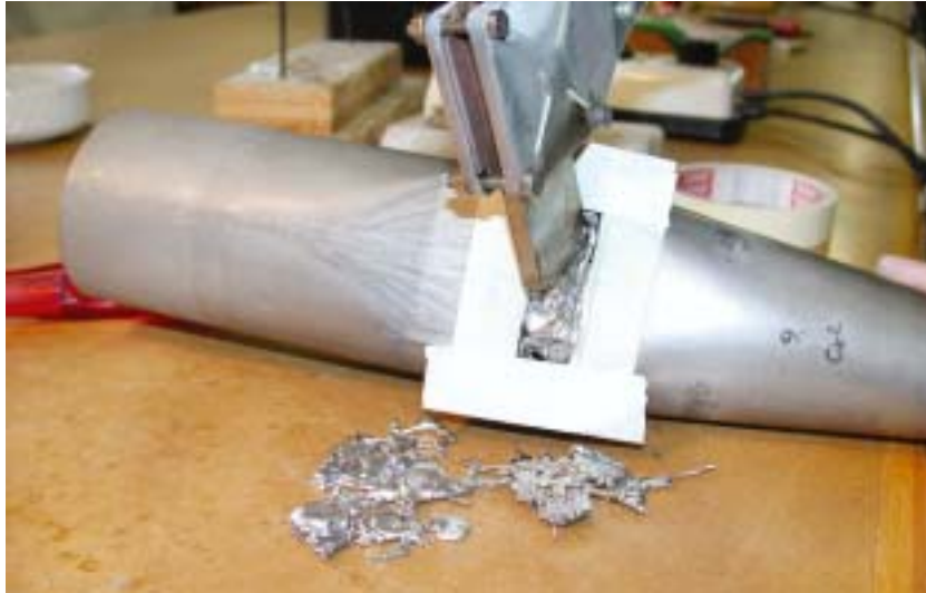
Extracción del metal fundido
