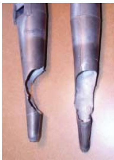
Caños del bourdon 8 antes de su reparación
