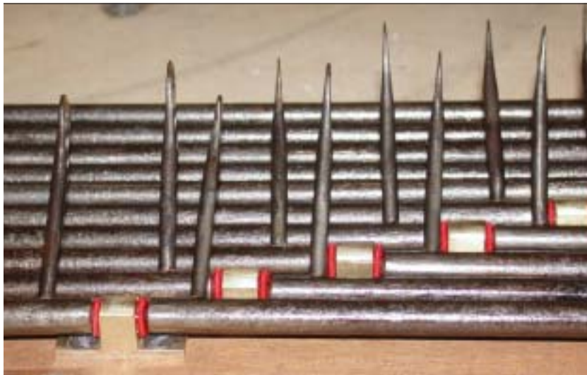
Rodetes de la reducción después de ser restaurados
