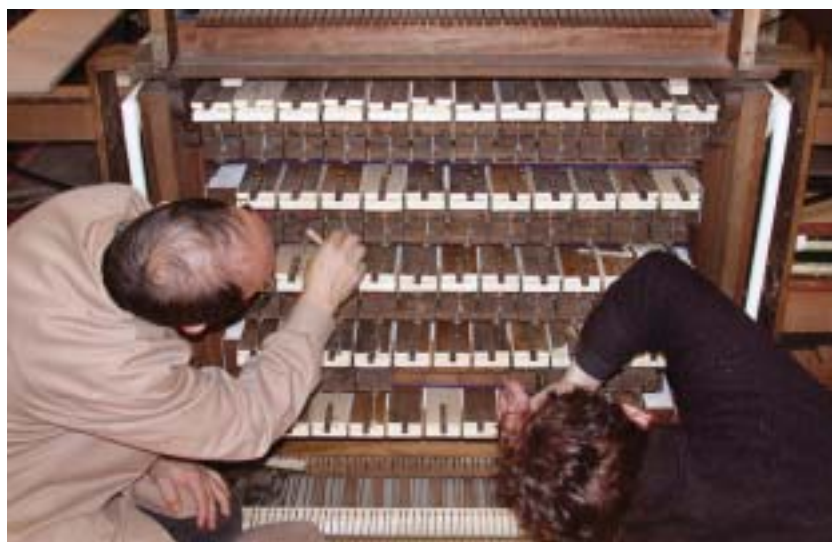
Ajuste de la máquina Barker
