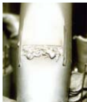
Metal fundido asomando por la boca de un tubo labial
