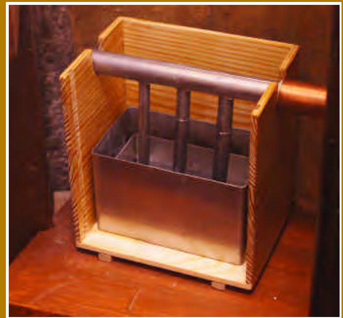
Mecanisme de l'orgue que reprodueix el cant d'uns ocells.
