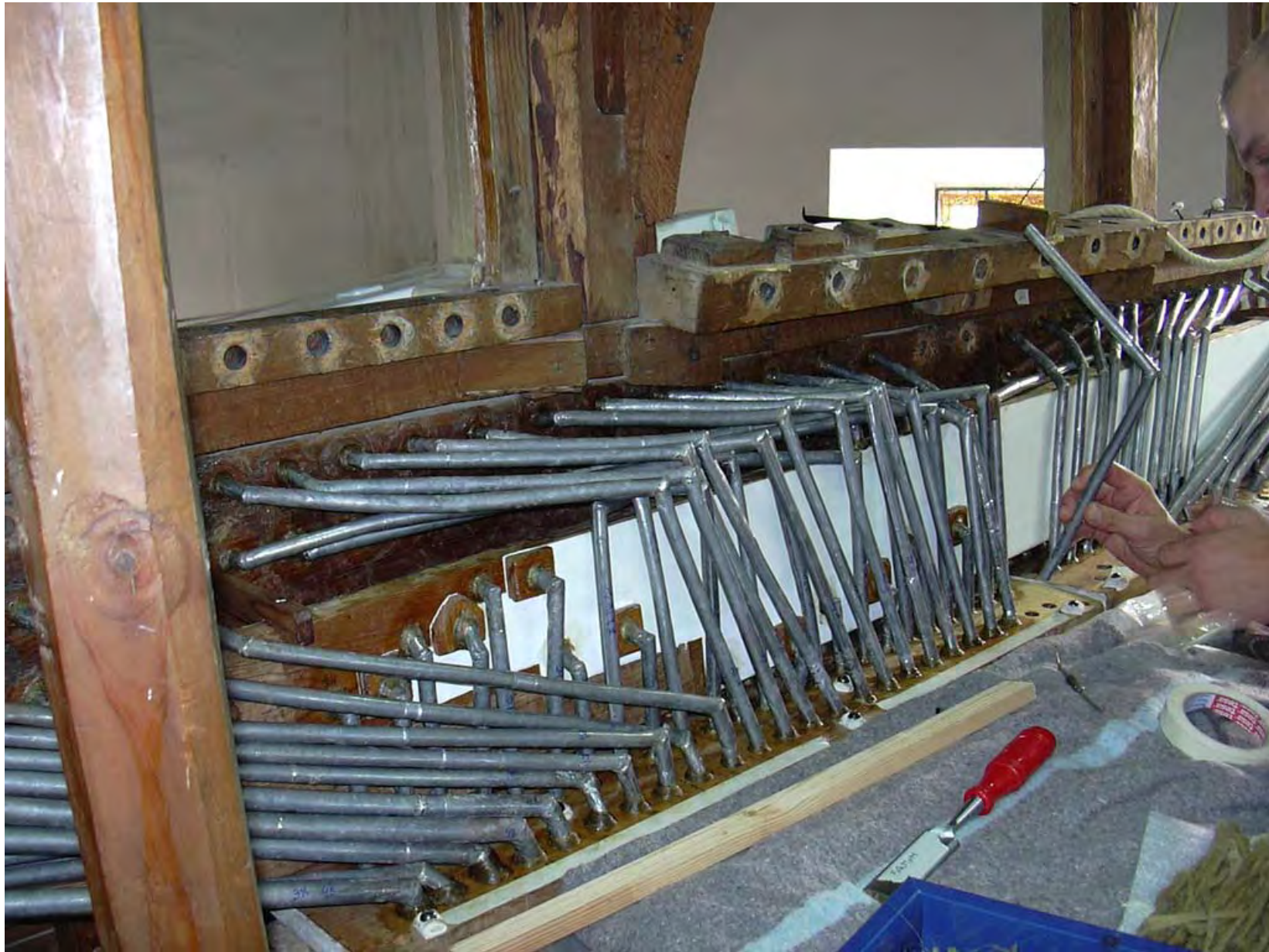
Proceso de montaje de tablonos y portavientos
