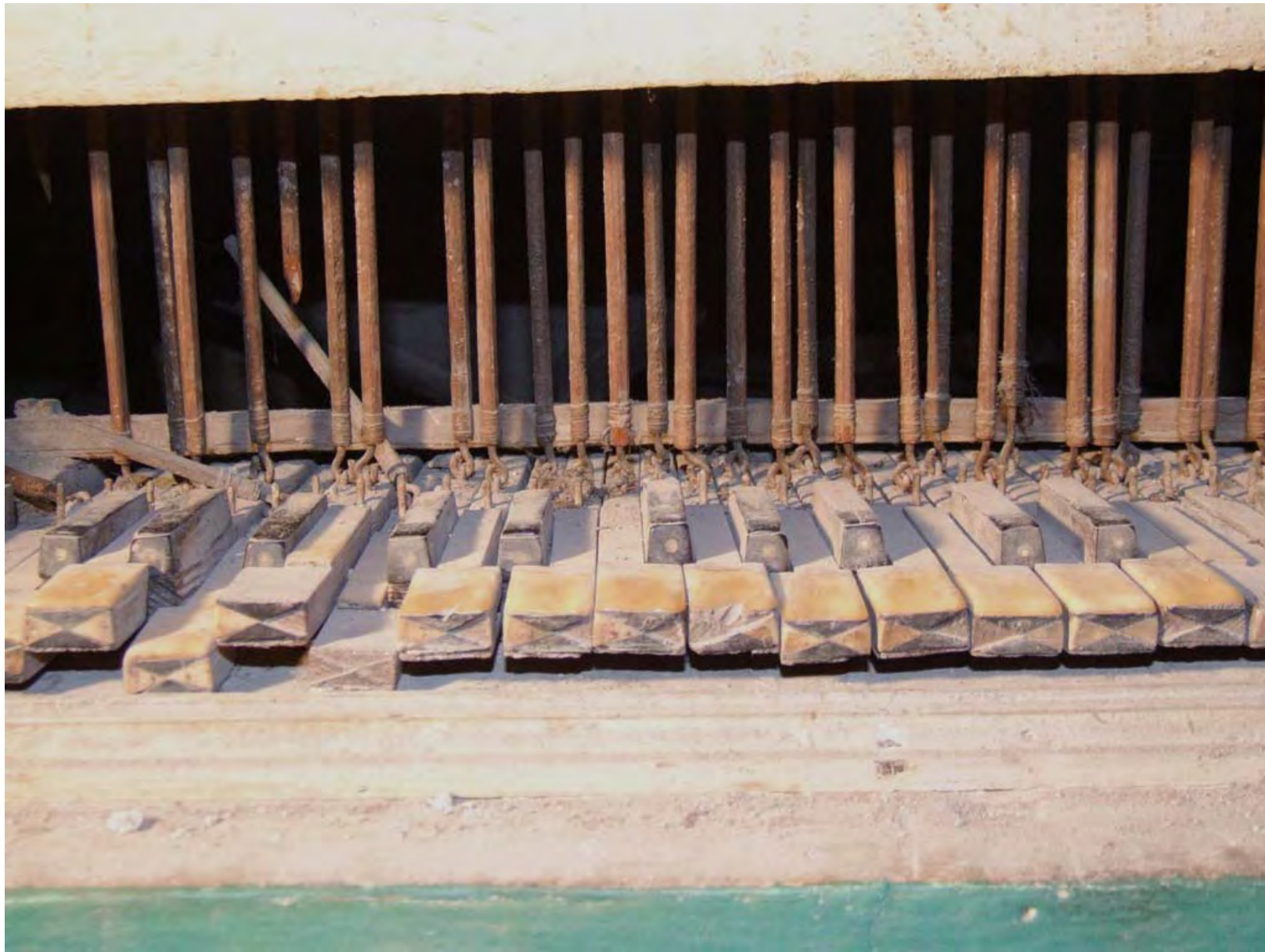
Detalle del deterioro de los elementos decorativos del teclado
