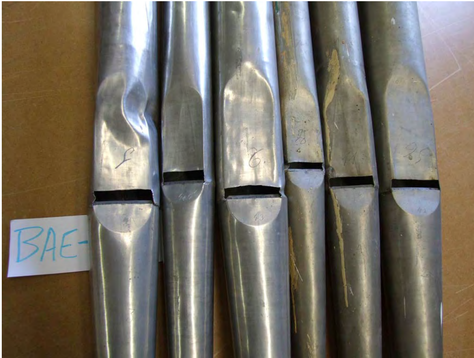
Tubos de fachada durante el proceso de limpieza
