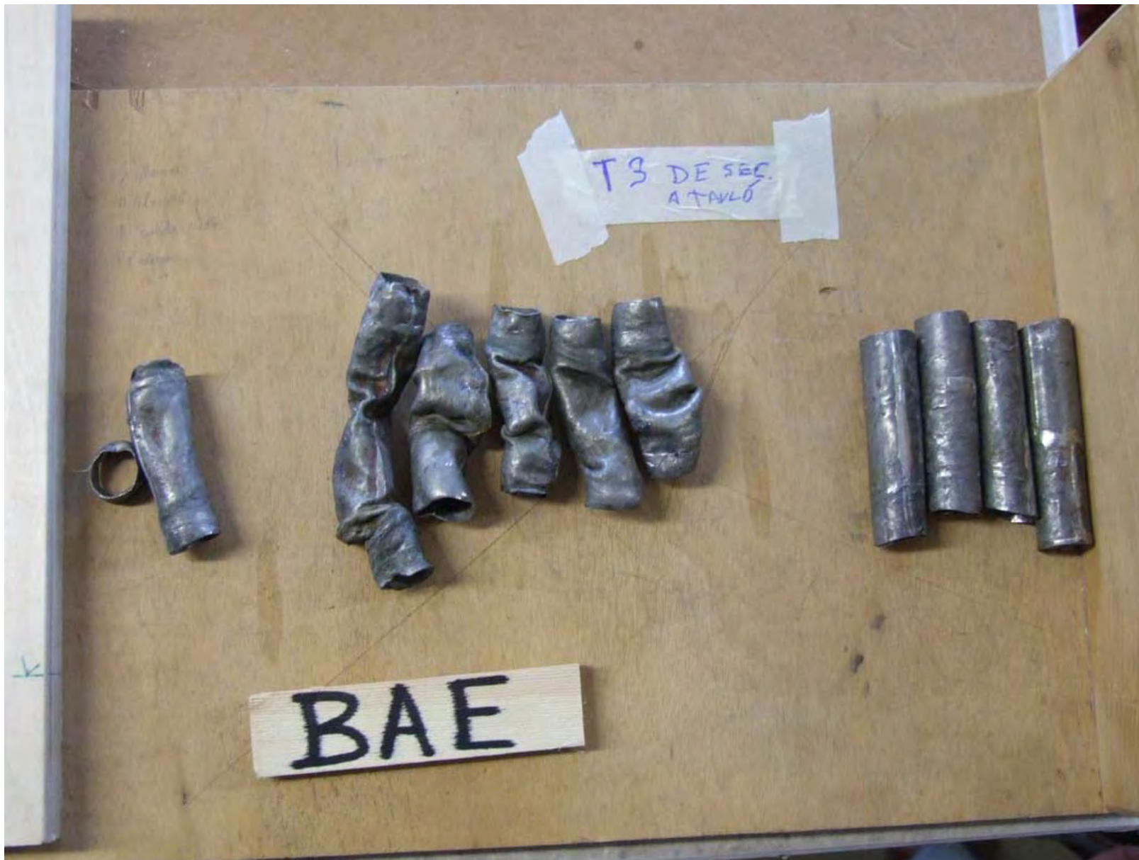
Detalle de la restauración de los portavientos de estaño
