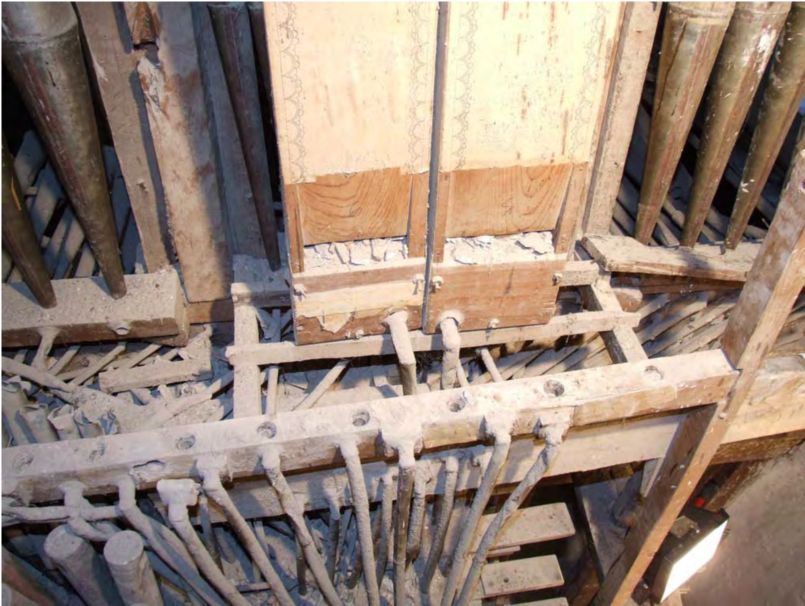
Vista de los tablonos aconductados y los portavientos antes del desmontaje
