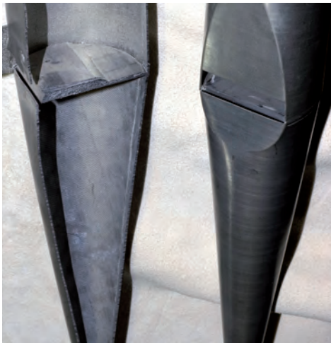
Fig. 19 Tub d'orgue (Fotografies: arxiu G. Grenzing) b) Secció d'un tub d'estany
