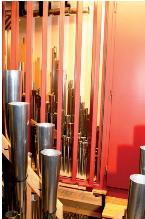
Fig. 7 Caixa expressiva. (Fotografies: arxiu G. Grenzing). Persianes de la caixa expressiva completament obertes: el so dels tubs és directe.
